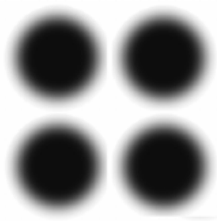
Slika 9 - Optički prirast rasterske vrijednosti uslijed bočnog raspršenja [5].
