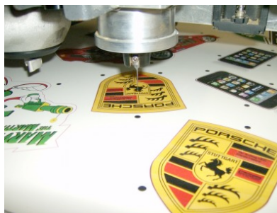
Slika 5 Izrezivanje otisnutog materijala sa oznakama pasera [4]
