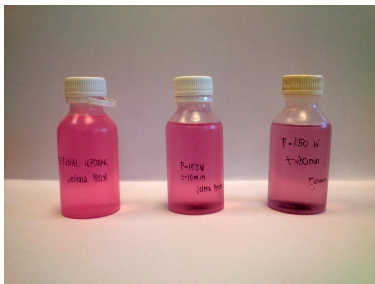
Slika 11. Usporedba originala i ultrazvučno ozračenih uzoraka snagom ultrazvuka od 150 W pri različitim vremenima trajanja ozračivanja
