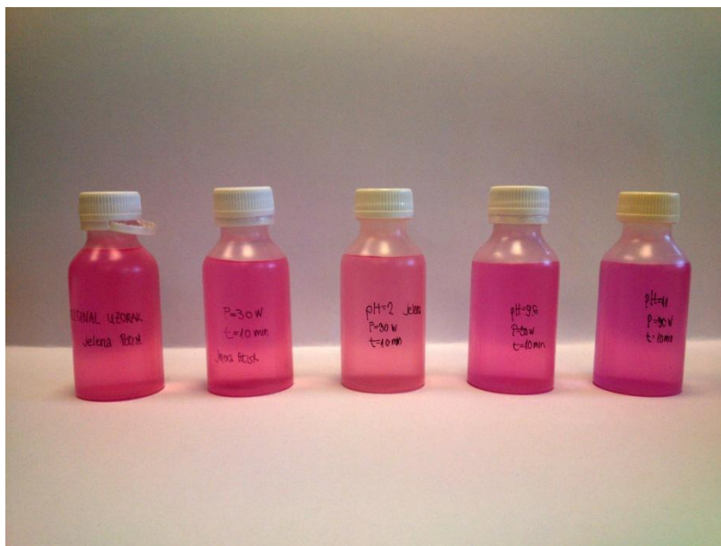
Slika 12. Usporedba originala i uzoraka ultrazvučno ozračenih snagom ultrazvuka od 30 W s vremenom 10 min te različitog pH
