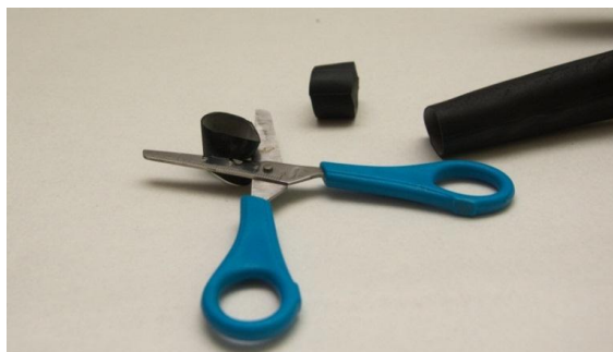
Slika 6. Način izrade kočnica za cameru obscuru
