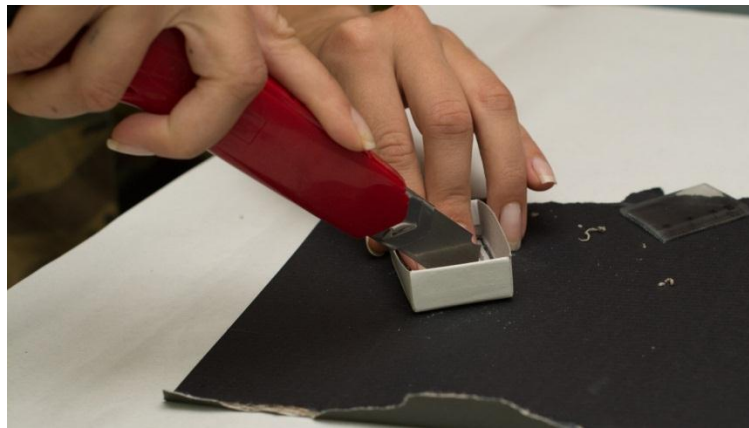
Slika 7. Izrezivanje otvora za film
