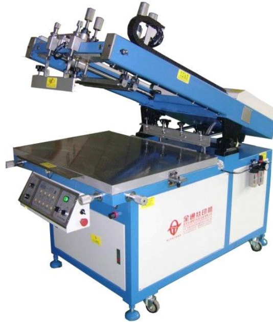
Slika 9: Suvremeni poluautomatski stroj sa ručnim ulaganjem i izlaganjem araka
