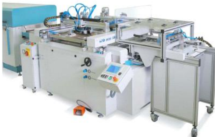
Slika 10: Potpuno automatski tiskarski stroj za sitotisak
