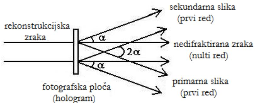
Slika 11. Rekonstrukcija slike transmisijskog holograma
