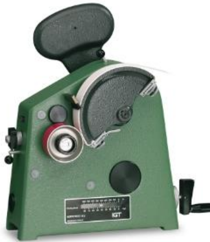
Slika 5. IGT uređaj tipa A2 [8] [materijali – vježbe - čupanje]
