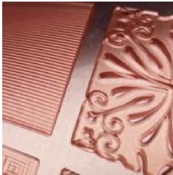
Slika 3. Fotopolimerna tiskovna forma ( http://www.etigraf.hr/proizvodnja.html )
