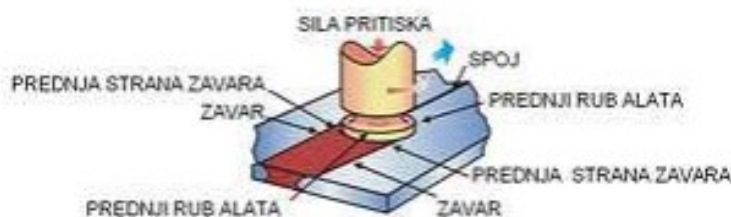
Slika 6. Zavarivanje trenjem s okretnim alatom
