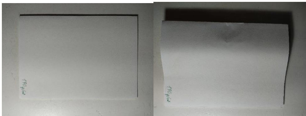
Slika 19. Papir gramature 170 g/m 2 prije (lijevo) i poslije (desno) 100 otvaranja [vlastiti rad]
