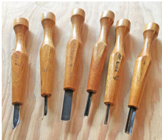
Slika 8. alati za ručno utiskivanje [pinterest.com]
