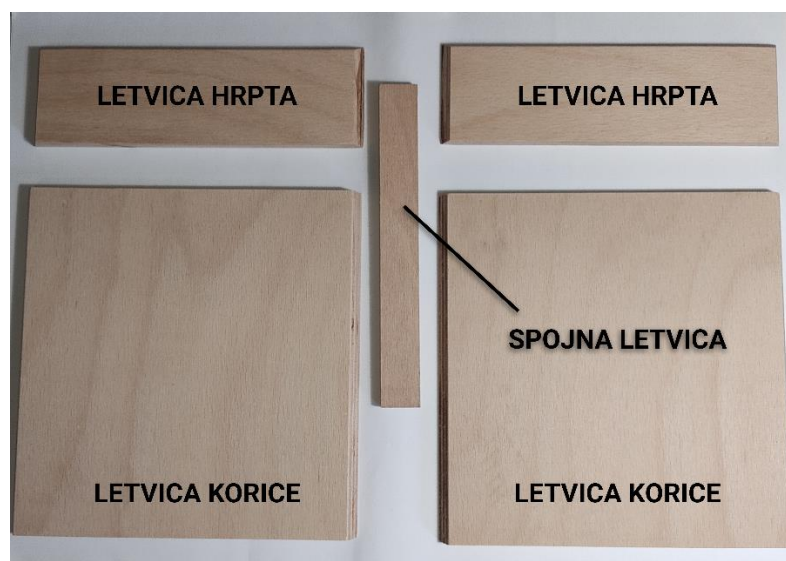
Slika 29. Dijelovi koji čine koricu i hrbat [vlastiti rad]
