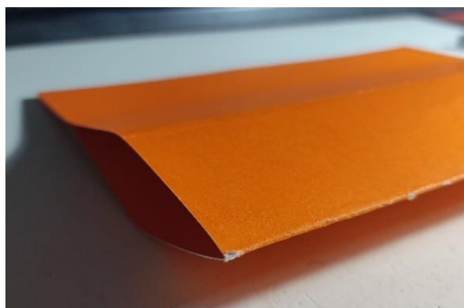
Slika 22. Oštećene na bridu stranice [vlastiti rad]
