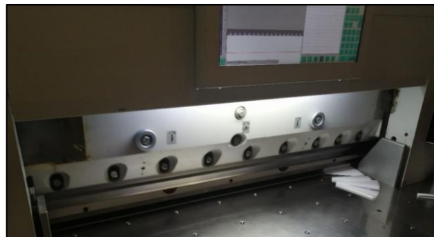
Slika 74. Obrezivanje knjiga u brzorezaču
