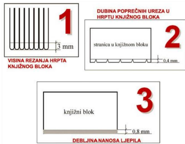
Slika 40. Postupak rezanja, urezivanja i nanosa ljepila na hrbat
