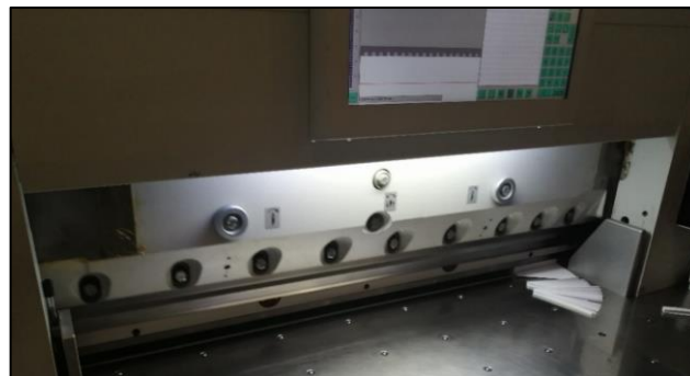
Slika 74. Obrezivanje knjiga u brzorezaču
