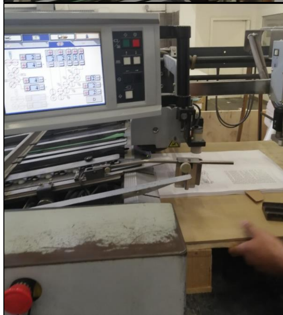
Slika 59. Odabir načina savijanja i postavljanje araka na paletu
