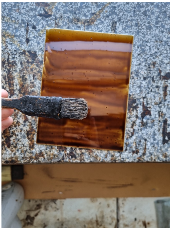
Slika 20: Premazivanje pločice zaštitnim asfaltnim lakom
