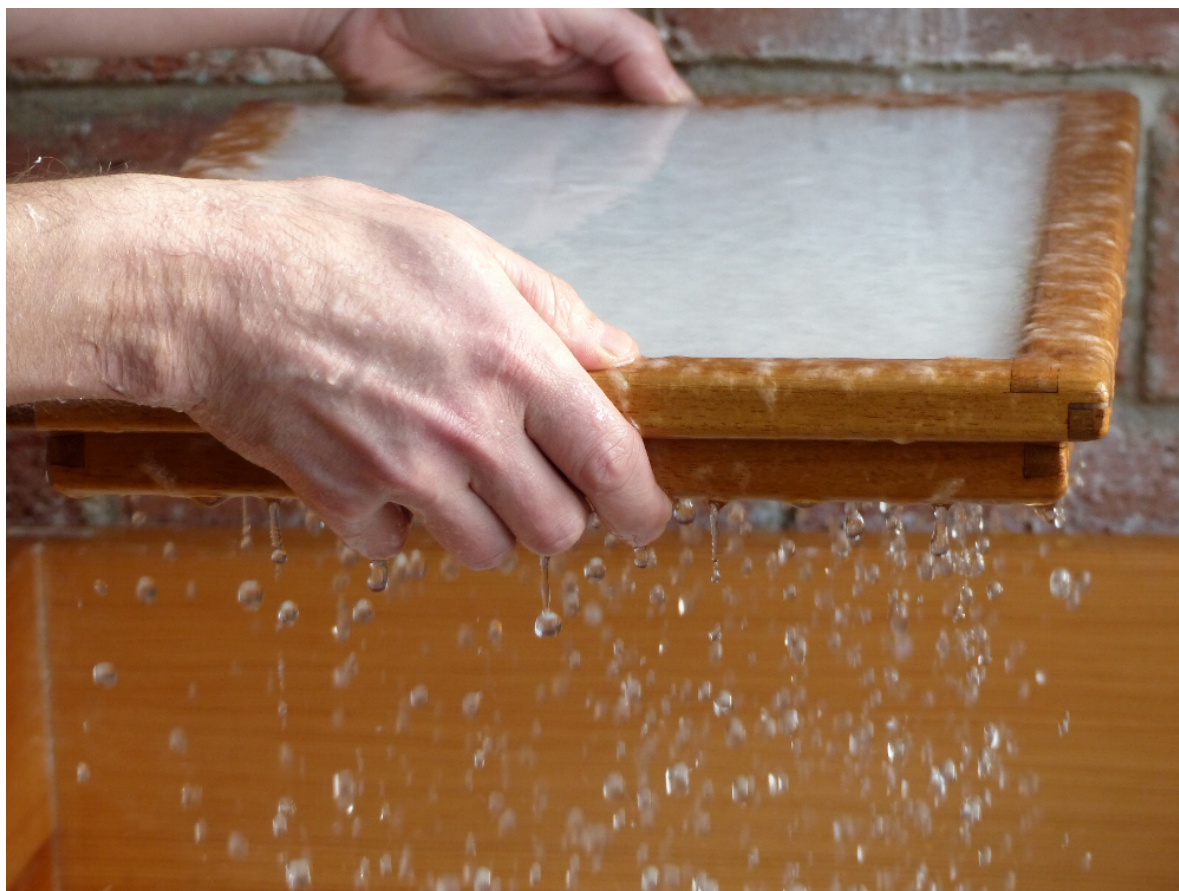
Slika 17: Ručna izrada papira
