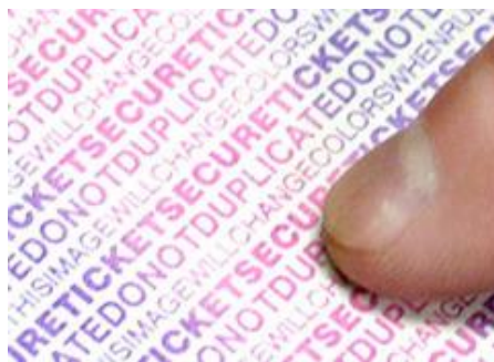
Slika 2 Termokromno leukobojilo korišteno za autentičnost dokumenata
