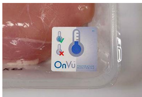
Slika 10 OnVu vremensko-temperaturni indikator
