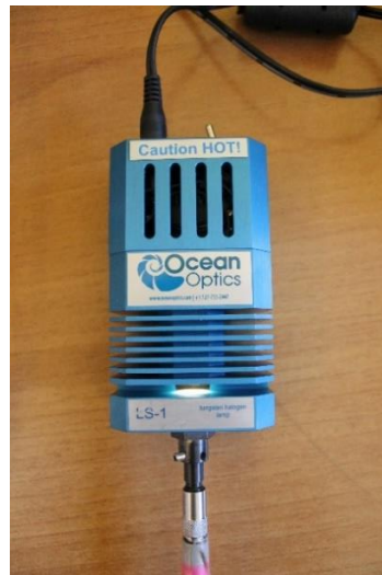
Slika 15 Prikaz izvora svjetla Ocean Optics LS-1
