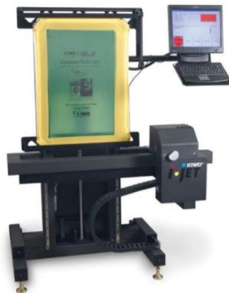
Slika 6. Izrada tiskovne forme za sitotisak CtP tehnologijom
