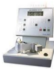
Slika 19. LORENZTEN AND WETTRE BENDING TESTER
