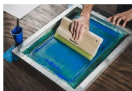
Slika 1. Proces otiskivanja u sitotisku
