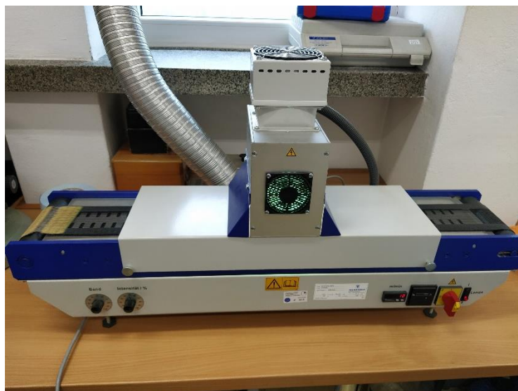
Slika 7. UV sušionik Akрилprint L (Technigraf, Njemačka)
