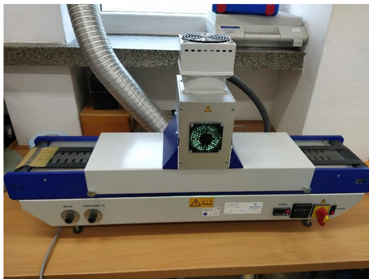
Slika 7. UV sušionik Akрилprint L (Technigraf, Njemačka)
