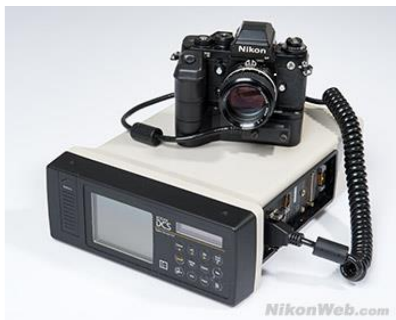
Slika 7: Kodak DCS kamera sa svojom digitalnom memorijskom jedinicom (DSU)
