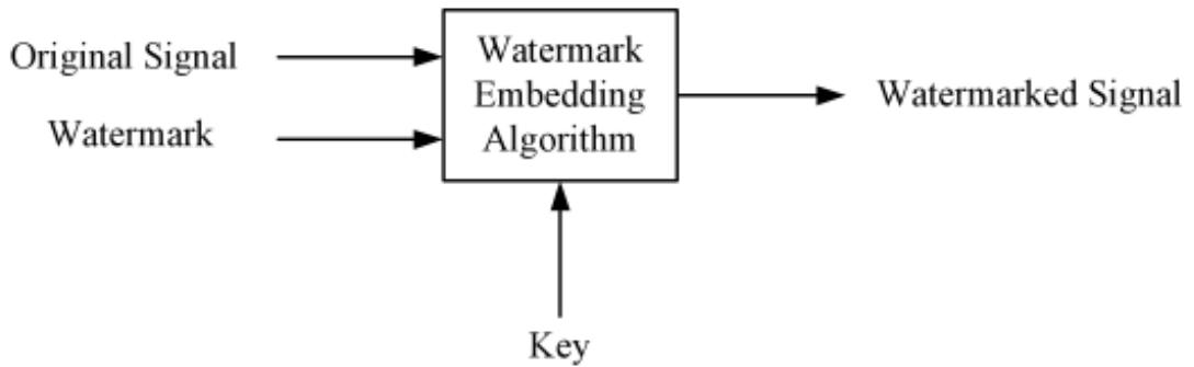
Slika 3. Shema umetanja digitalnog vodenog žiga [3]
