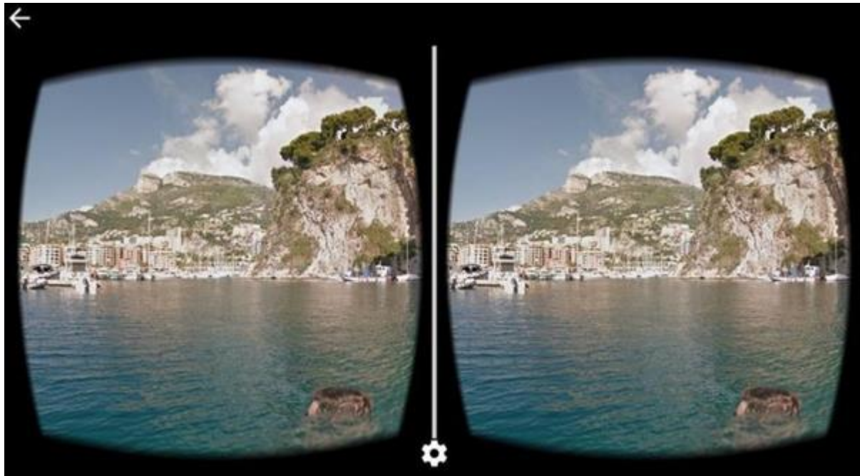
Slika 3. Prikaz dvostrane slike na zaslonu promatranja VR naočala
