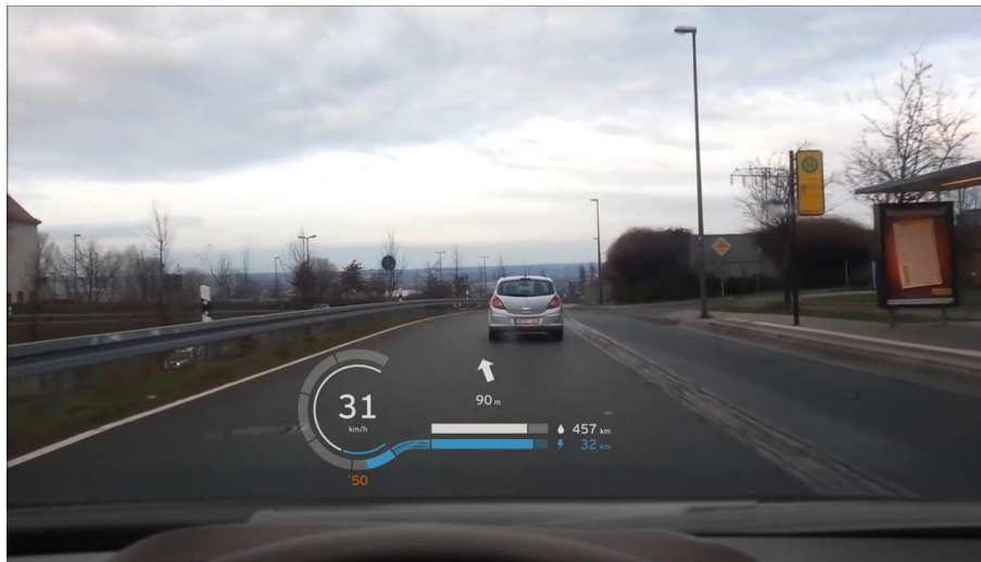
Slika 4. HUD prikaz na vjetrobranskom staklu, ( izvor: https://bit.ly/3gtZCYz )
