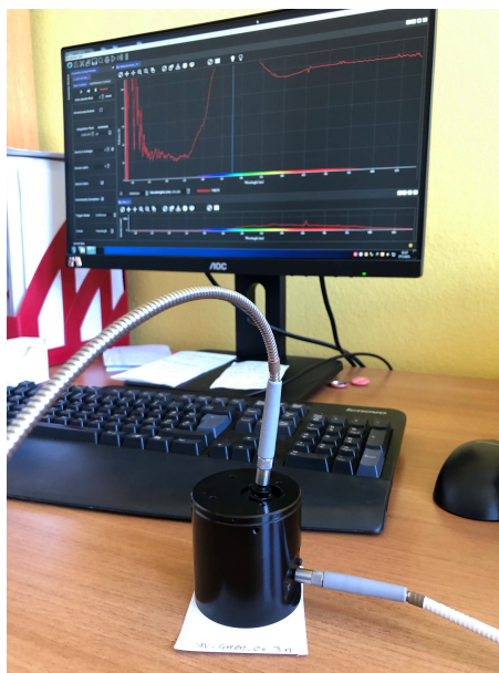
Slika 20. Mjerenje spektrometrom Ocean Optics USB 2000+
