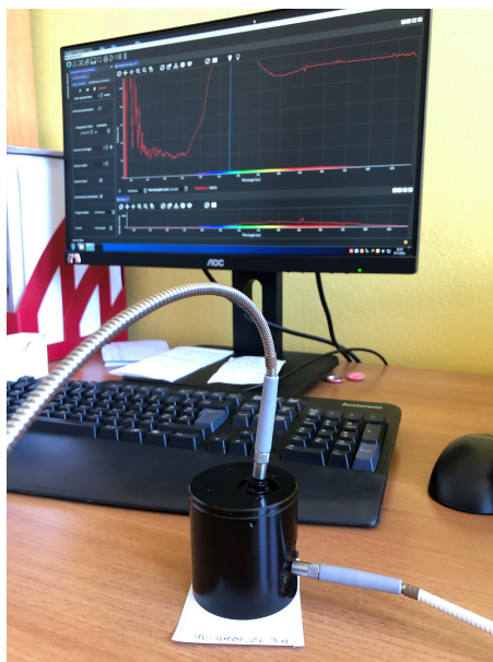
Slika 20. Mjerenje spektrometrom Ocean Optics USB 2000+
