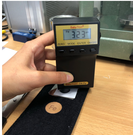
Slika 19. Uređaj SaluTron D4
