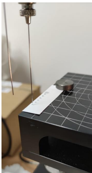
Slika 29. Prikaz postupka mjerenja kontaktnih kuteva
