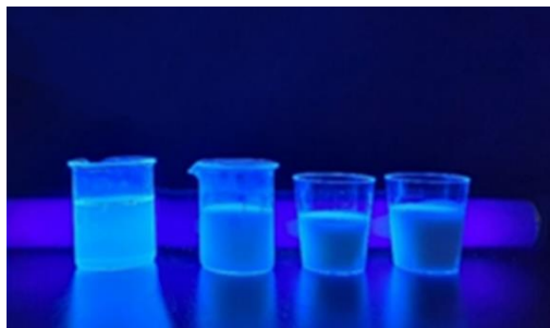
Slika 15. Tiskarska boja s dodatkom nanočestica (s lijeva na desno: UV_FB, UV_FB + 0,5% TiO 2 , UV_FB + 1% TiO 2 , UV_FB + 1,5% TiO 2 )
