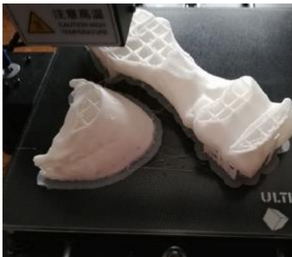
Slika 22. Izrada 3D modela konjskog uda sloj po sloj
