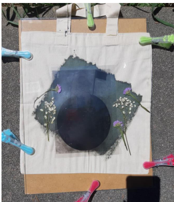
Slika 21. Osvjetljavanje tekstilne podloge pomoću folije s negativom
