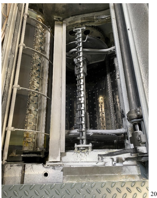
Slika 20. Venturi tehnologija i hvataljke izlagaćeg aparata
