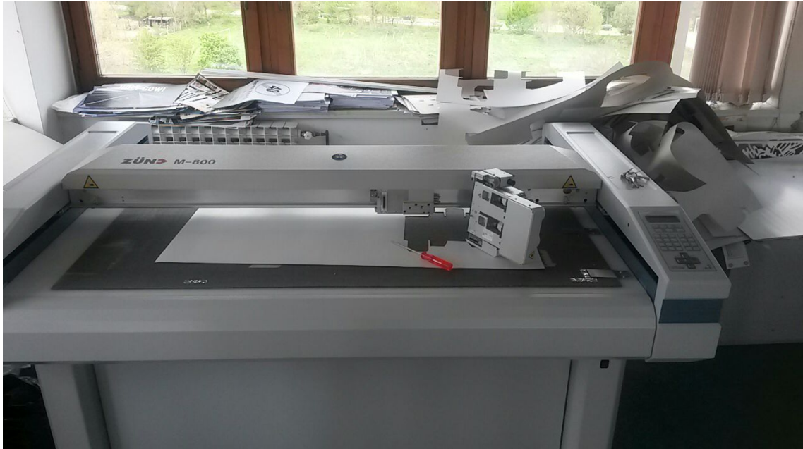
Slika 16. Fotografija kompletnog stolnog rezača Zund M800
