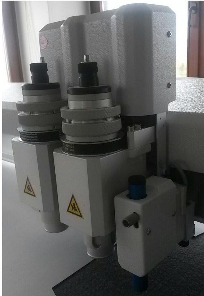
Slika 15. Fotografija alatne glave stolnog rezača Zund M800
