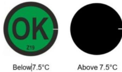
Slika 3: Tip TLC na termometrima hladnjaka koji prikazuje riječ "OK" kada je temperatura ispod 7,5°C [9]
