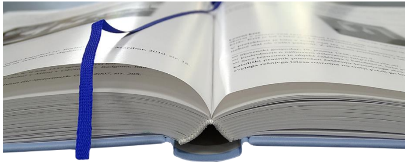
Slika 6. Indirektna veza između knjižnog bloka i korica
