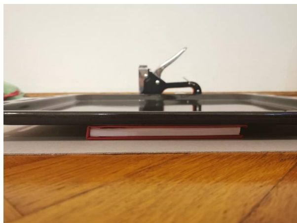
Slika 17. Spajanje knjižnog bloka i korica te prešanje
