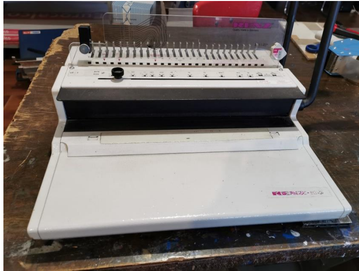
Slika 23. Uređaj za perforaciju i uvez spirale
