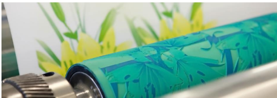
Slika 4.27 Sleeve tiskovna forma[13]
