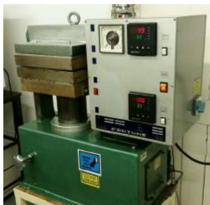
Slika 5.2 Fontune, uređaj za prešanje
