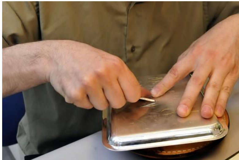
Slika 2.1 Ručno graviranje srebra[2]
