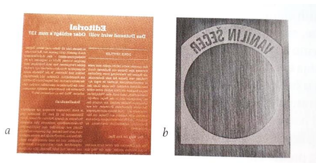
Slika 4.35 Elektrogravirna tiskovna forma za duboki tisak bakrena (a) i kromirana (b)
