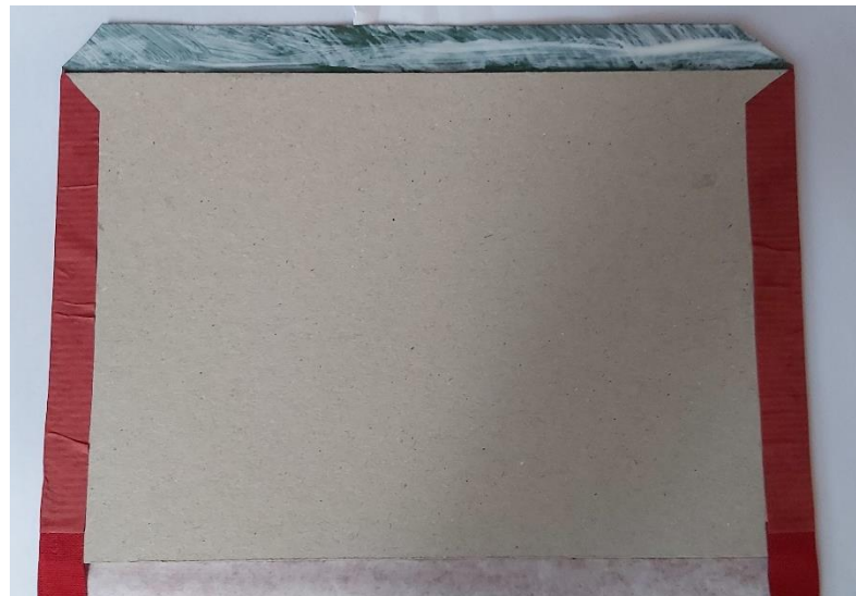
Slika 40. Zarubljivanje presvlake preko prireza
