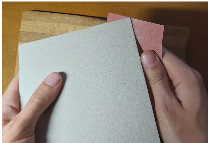
Slika 28. Brušenje rubova brusnim papirom
