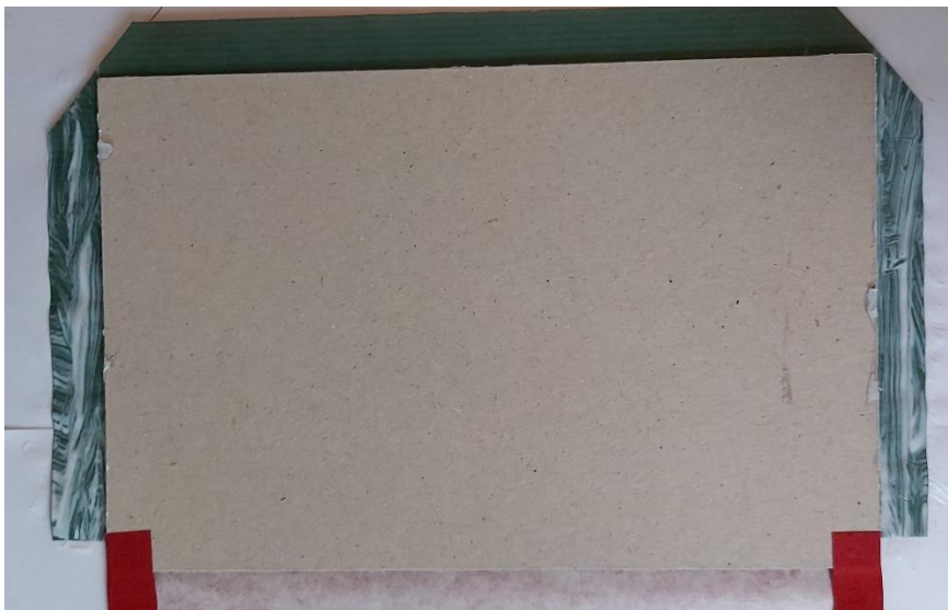
Slika 39. Uljepljivanje prireza na presvlaku
