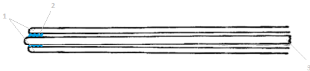
Slika 42. Obična podstava povezana s knjižnim blokom; 1 – list podstave, 2 – lijepljeni dio, 3 – knjižni blok
