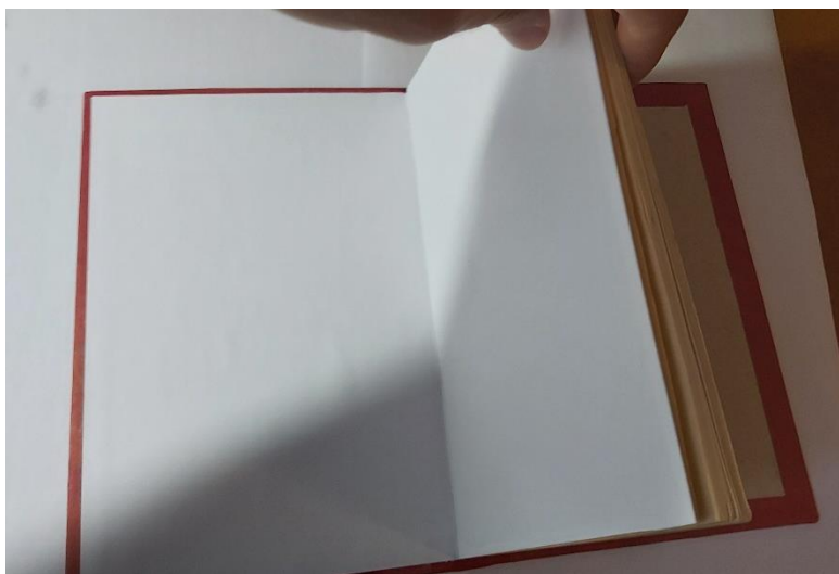
Slika 49. Uljepljivanje prve podstave na korice
