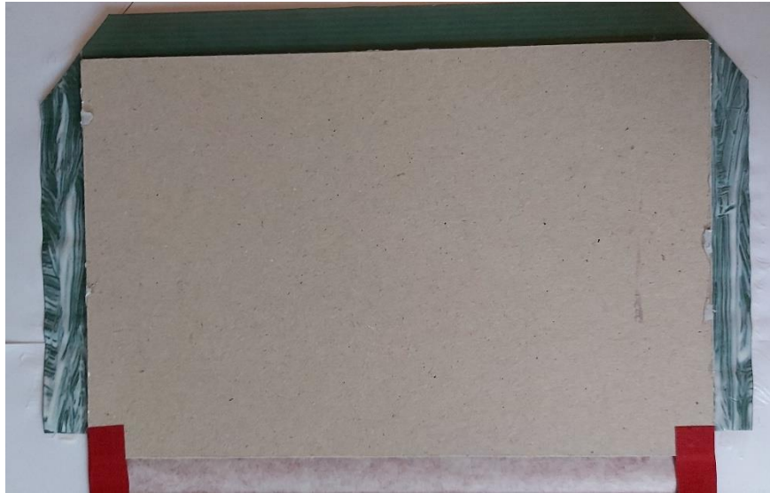
Slika 39. Uljepljivanje prireza na presvlaku
