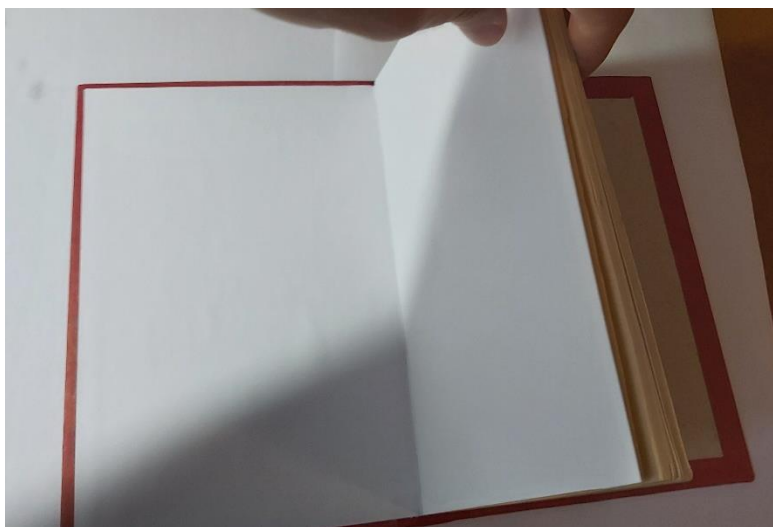
Slika 49. Uljepljivanje prve podstave na korice
