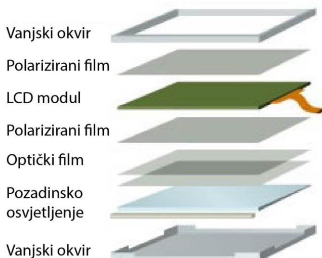
Slika 5. Dekonstruirani LCD monitor s polarizatorima
