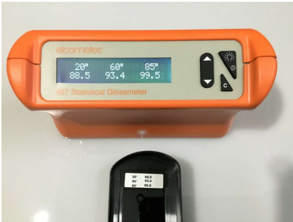
Slika 16. Prikaz mjerenja na glossmetru
