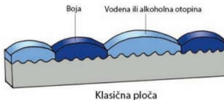
Slika 1. Prikaz navlažene i obojane aluminijske tiskovne forme za plošni tisak
