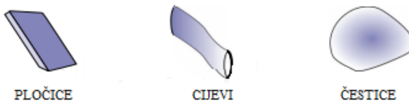
Slika 7. Vrste nanopunila s obzirom na strukturu
