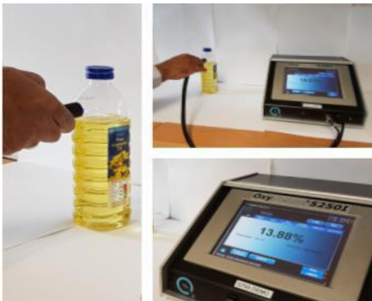
Slika 5. Uređaj za otkrivanje prisutnosti kisika unutar ambalažnog proizvoda [4]
