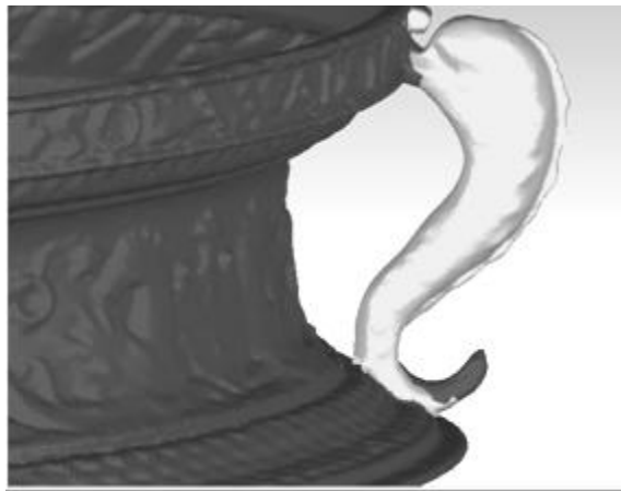
Slika 21. Preklapanje dvaju modela dobiveno globalnom registracijom
