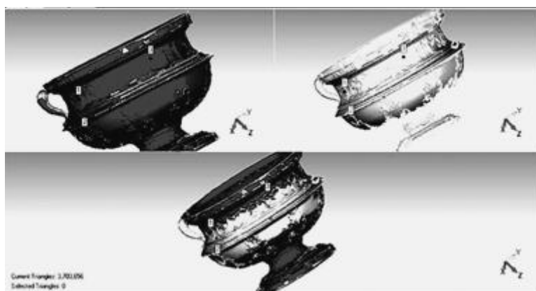
Slika 8. Selekcija zajedničkih točaka na preklopu dva dijela modela dobivenih skeniranjem.
