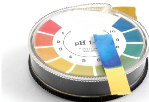
Slika 2. Halokromna boja u pH indikatorskoj traci
