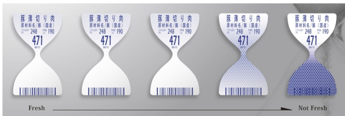
Slika 13. Princip rada Freshness Label naljepnice
