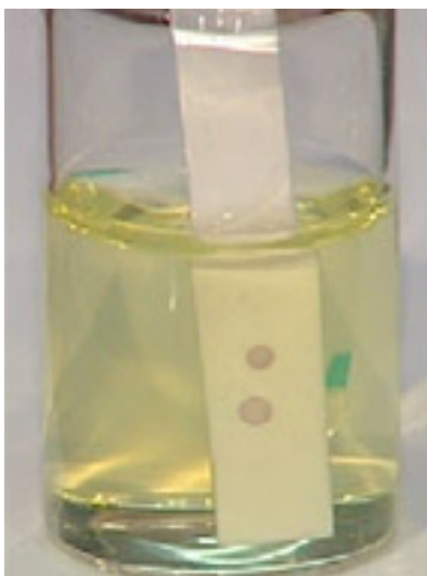
Slika 22. Papir tretiran enzimima mijenja boju u doticaju s testnom otopinom
