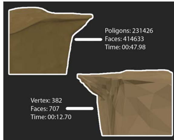
Slika 63: Usporedba high i low poly modela
