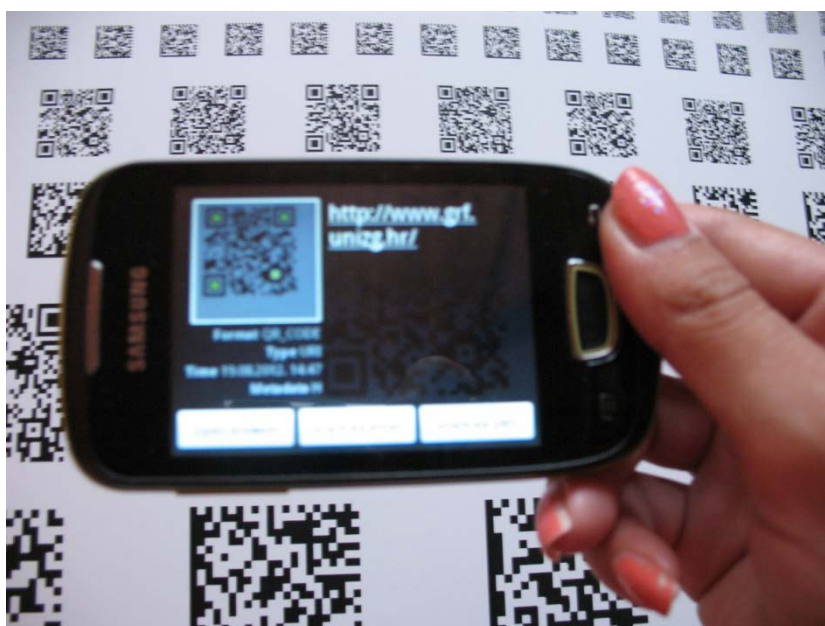
Slika 51. Ispitivanje čitljivosti kodova barkod čitačem instaliranim na mobilni uređaj
