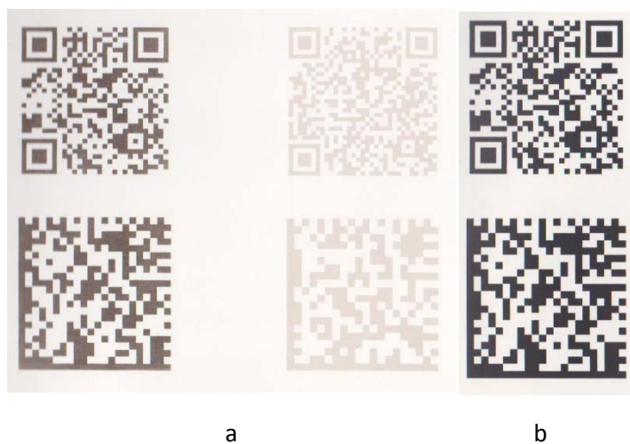
Slika 50. Odabrani kodovi za ispitivanje čitljivosti Termokromni otisak (a), Otisak UV crnom (b)
