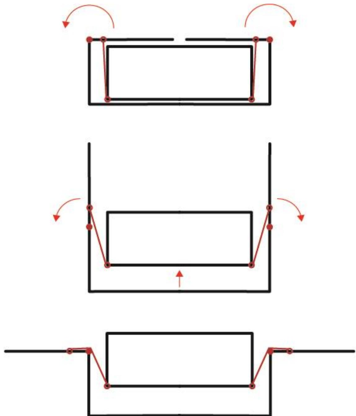
U mojoj kutiju odlučio sam primjeniti isti mehanizam, al na malo drugačiji način. Umjesto da poklopac kutije uzdiže obje strane te ravnomjerno podiže središnji dio kutije, primjenio bi mehanizam samo sa jedne strane, dok je sa druge fiksirana u jednom pravcu za vanjski dio kutije, tako da se središnji dio sa proizvodom u tom slučaju nagnje prema korisniku i automatski kao da izlaže proizvod, daje bolji kut gledanja na njega...
