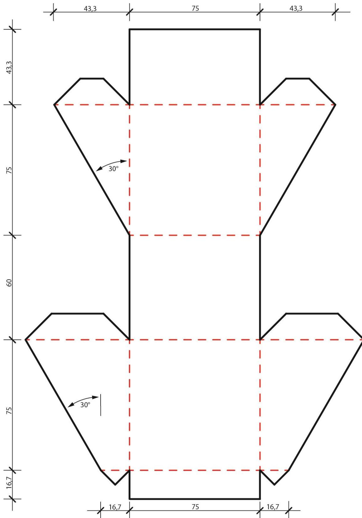
Plavo isprekidane crte je potrebno bigati sa suprotne strane od crveno isprekidanih.
