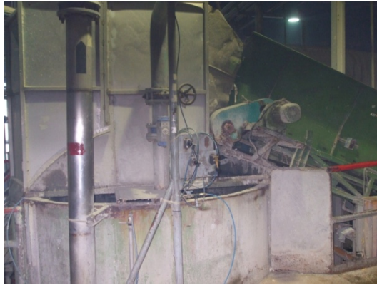
Slika 29 - Pulper iz kojeg se uzima uzorak smjese za kontrolu
