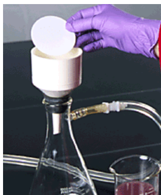
Slika 30 - Buchnerov lijevak spojen na vakuum
