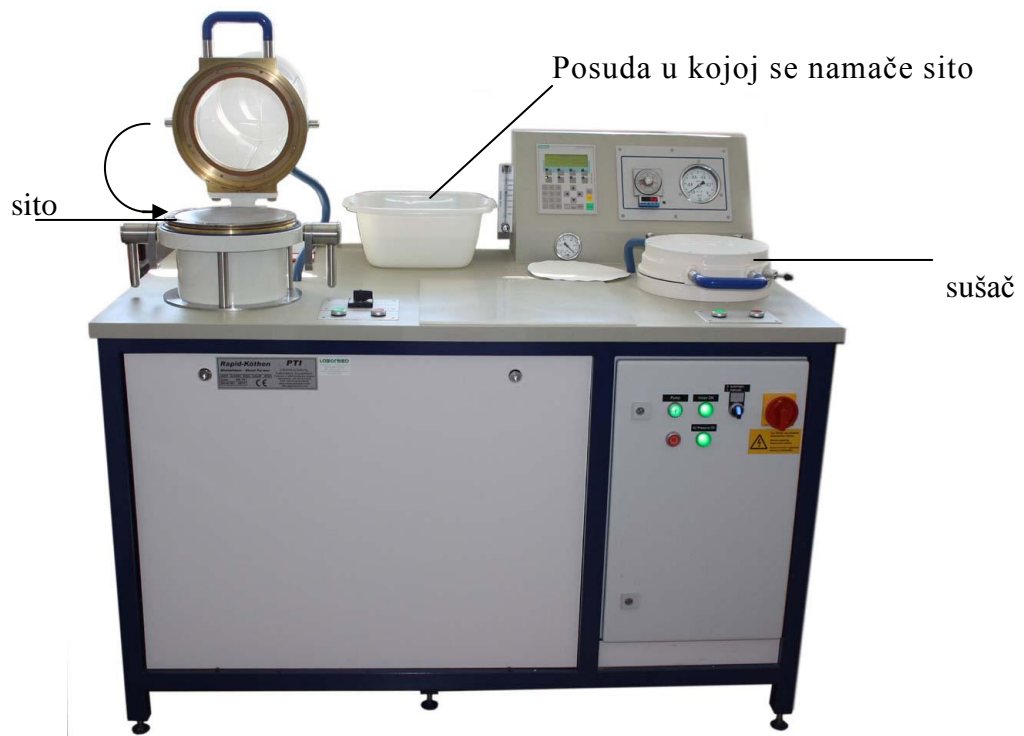
Slika 16. Rapid Kothen Sheet Former (PTI) uređaj
