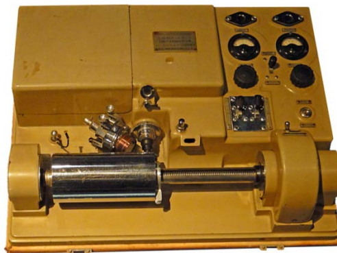
Slika 1. Belinograf BEP2V, fototelegrafski stroj, izumio Edouard B  lin, 1930.
