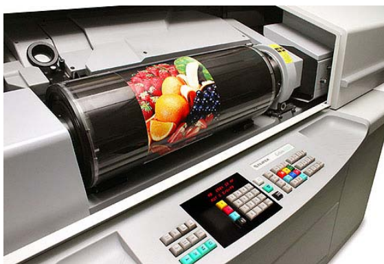
Slika 6. Skener rotacijskog tipa
