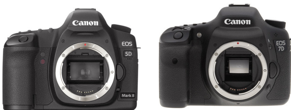
Slika 19. Veličina senzora kod Canon 5D (full-frame) i Canon 7D (crop 1.6x)
